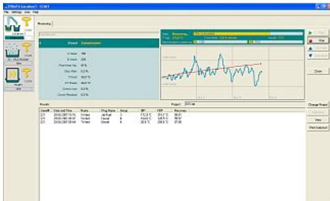
Mittels PC und der Datenmanagementsoftware MINIWIN kann man Geräte von Grabner Instruments komfortabel bedienen. Über die serielle RS232 Schnittstelle ist das Gerät mit dem PC verbunden und kann mit der Software MINIWIN ferngesteuert bedient werden. Ergebnisse und Daten können ebenfalls leicht erfasst und abgespeichert werden. Mit MINIWIN lässt sich das Gerät in das LIMS System leicht integrieren.
