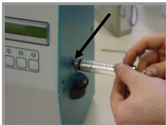
Diese Menge Öl reicht für mehr als 2000 Messungen. Sollte das Gerät transportiert worden sein, füllen Sie 2ml Öl nach.
