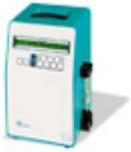
Diese Version ist indirekt mit der VPS Reihe „verwandt“, wird aber dort eingesetzt, wo die Flüssigkeits-/Dampf- Verhältnis Temperatur von Treibstoffen interessant ist. Der Messbereich liegt bei 20 bis 80°C (68 bis 176°F). Der nominale Druck für den Test kann zwischen 50 kPa und 200 kPa (7.25 and 29.01 psi) justiert werden. Die Verdampfungstendenz von Treibstoffen in Ottomotoren wird mit dem V/L Verhältnis angezeigt.
