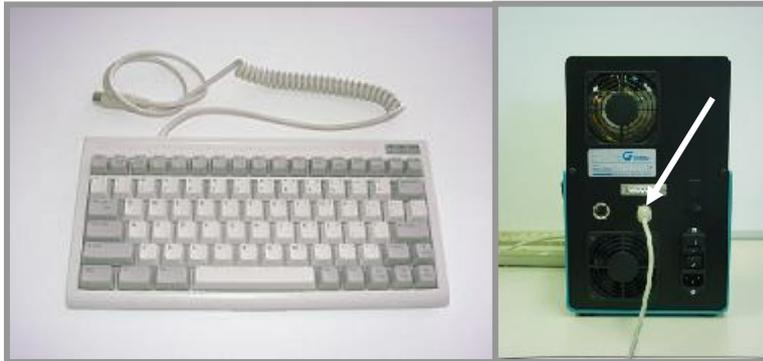
Auf der Rückseite des Geräts finden Sie einen runden Anschluss für eine PC-Tastatur (Verwenden Sie eine IBM PC-AT oder eine kompatible Tastatur)
