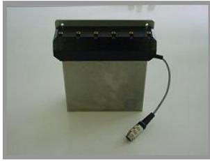
MINIVAP VPS kann mit einem 6-fach Probenverteiler ausgestattet werden. Für Routinemessungen wird automatisch der Dampfdruck von 6 Proben nacheinander ermittelt. Da die 6 Proben in Spritzen aufgezogen werden, wird ein Ausgasen verhindert und ein Erwärmen der Probe hat keinerlei Auswirkung auf den Dampfdruck.
